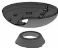
2. Ensuite, placez la partie inférieure sur le socle, avec l'ouverture dans la direction voulue.
